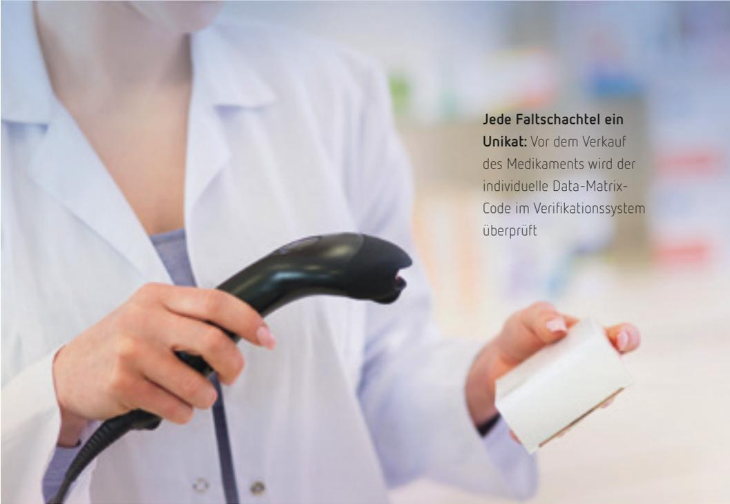
**Jede Faltschachtel ein Unikat:** Vor dem Verkauf des Medikaments wird der individuelle Data-Matrix-Code im Verifikationssystem überprüft
